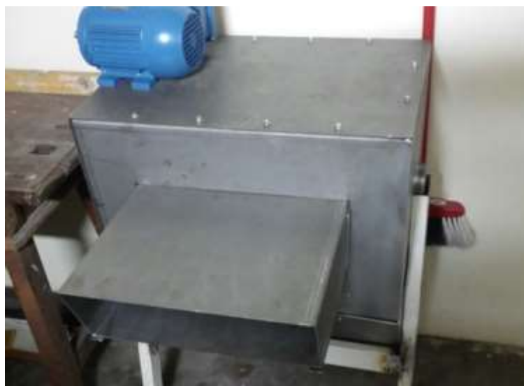
Figura 8: Carcaça da compactadora montada.
